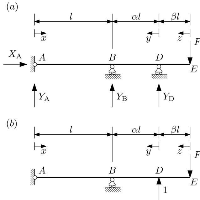
Si risolva la struttura staticamente indeterminata in figura (a) mediante il PLV. Si tratta di una singola trave di rigidezza flessione  $EJ$  e caricata al punto E da un carico concentrato  $F$ . Si seguano i passaggi seguenti per aiutarsi nella risoluzione dell'esercizio.
