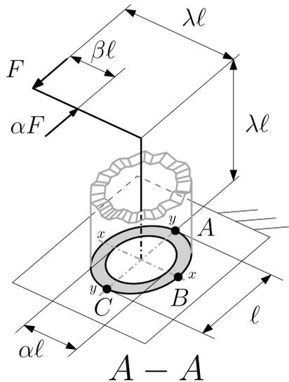
Si consideri la struttura trabeiforme in figura, incastrata alla base e caricata dai due carichi concentrati di intensità  $F$  e  $\alpha F$  e costituita da un profilato a sezione circolare cava di diametro esterno  $l$  e diametro interno  $\alpha l$ .
