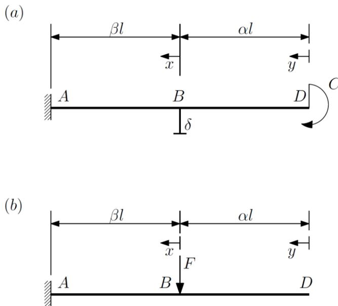
Si determini il valore dello spostamento  $\delta$  del punto B della struttura staticamente determinata di figura (a) tramite il teorema di Castigliano. Si tratta di una singola trave di rigidezza a flessione  $EJ$  e caricata al punto D da una coppia concentrata  $C$ . Si seguano i passaggi seguenti per aiutarsi nella risoluzione dell'esercizio.
