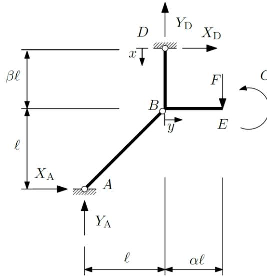
Considerare la struttura in figura, composta da travi di rigidezza flessionale  $EJ$  e caricata da un carico concentrato  $F$  sul punto E e da una coppia  $C$  al punto E.
