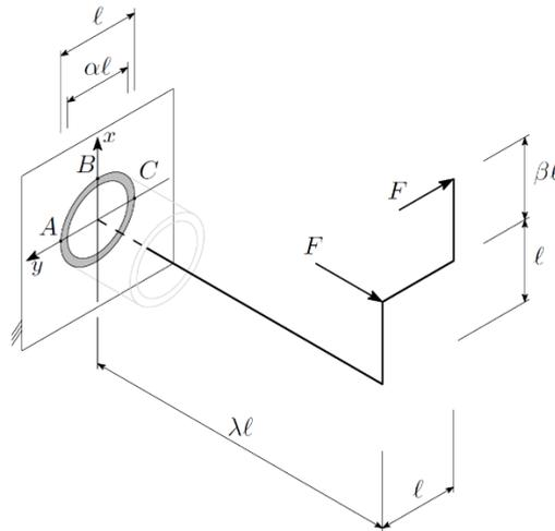
Si consideri la struttura trabeiforme in figura, incastrata in corrispondenza della sezione rappresentata e caricata da due forze concentrate di uguale intensità  $F$ . La trave è costituita da un profilato a sezione circolare cava di diametro esterno  $\ell$  e diametro interno  $\alpha\ell$ .
