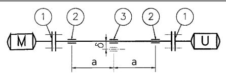
Si consideri l'albero di trasmissione di figura realizzato in acciaio C40 e caratterizzato da una sezione circolare cava di diametro esterno 26 mm e diametro interno 19 mm, supposta per semplicità costante.
