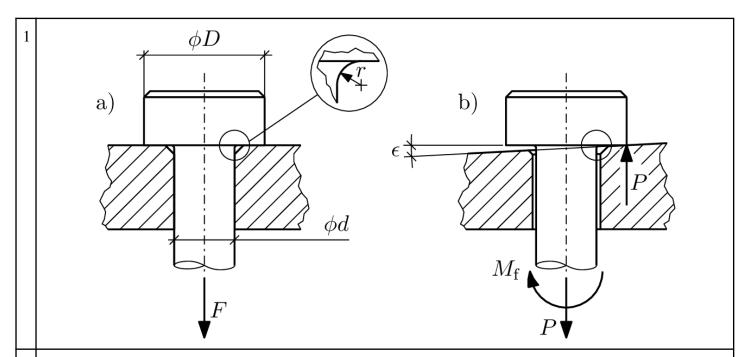
Si consideri inizialmente la barra a trazione in figura a), alla sezione di raccordo tra stelo e testa di battuta. Noto che:
